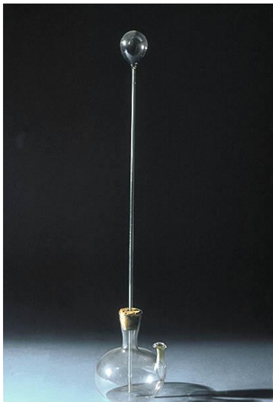
Modello di termoscopio galileiano (Istituto e Museo di Storia della Scienza, Firenze)
