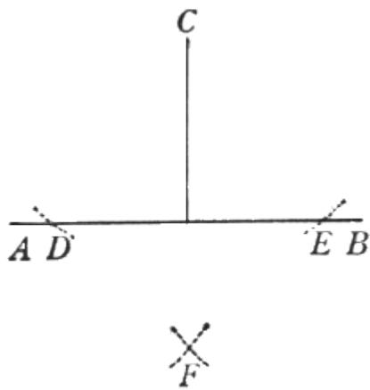
si deve sopra l' $AB$  far cadere la perpendicolare dal punto  $C$  posto fuori di essa. Il che faremo fermando un'asta del compasso nel punto  $C$ , ed allargando tanto che con l'altra si possano notare nella linea  $AB$  li due punti  $D, E$ ; sopra i quali fermando una delle aste, con l'altra si farà l'intersecazione  $F$ ; e posta la riga sopra i punti  $C, F$ , tireremo la linea  $CG$ ; quale sarà perpendicolare.
