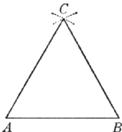
Aprasi il compasso; e presa la distanza di essa linea  $AB$ , fermando l'asta nei punti  $A, B$ , facciasi con l'altra l'intersecazione al punto  $C$ , dal quale tiransi l'altre due linee ai punti  $A, B$ : e sarà fatto il triangolo.
