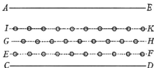
dove *AB* è il filo di fuori e *CD* quello di dentro, ed i pali vanno piantati secondo le linee *EF*, *GH*, *IK* con l'ordine che dimostrano i segni *O*. E basterà che detti pali siano fitti in terra solamente tanto che stiano dritti, perché, nel riempier poi di terreno, vanno sotterrati. Ma bisogna avvertire, che siano dritti e senza nodi, acciò che la incatenatura, che tra essi va intrecciata, possa senza impedimento abbassarsi, secondo che il terreno avvallerà.
