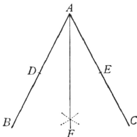
Sia l'angolo  $BAC$ ; e posta un'asta del compasso in  $A$ , notisi con l'altra li due punti  $D, E$ , sopra i quali si farà l'intersecazione nel punto  $F$ ; e tirando la linea retta dall' $A$  a  $F$ , sarà da essa segato l'angolo in eguali parti.
